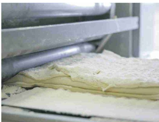
Hier wird der Teig von vier Zentimeter auf vier Millimeter gewalzt.
